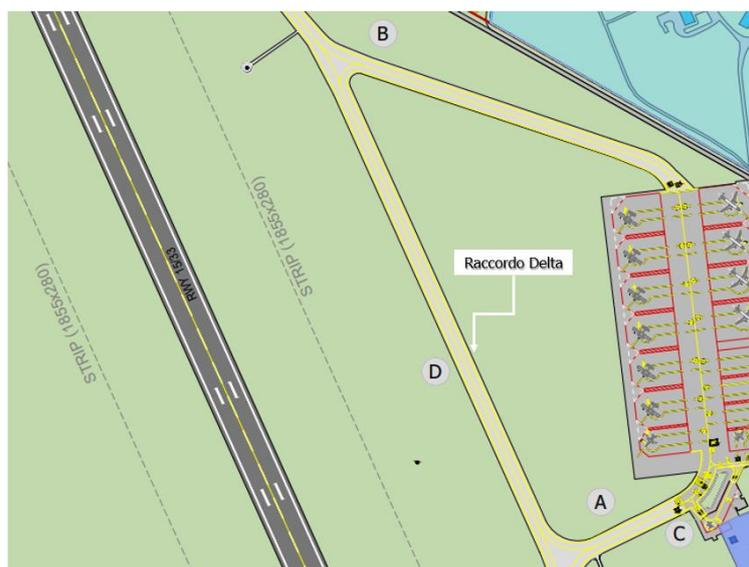
Figura 6-2 Nuova taxiway "Delta" prevista nella configurazione dello scenario di sviluppo
